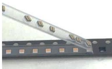
图 18. 静电导致的 LED 粘连
