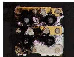
突入电流引起的损伤 (芯片电极)
